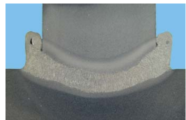
Kopfbolzenschweißung ohne innere Fehler mit hohem Schweißwulst (bevorzugt im Verbundbau, konform mit den Anforderungen nach Eurocode 4)
