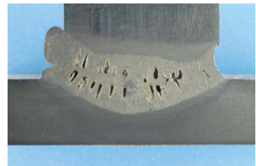
Kopfbolzenschweißung mit Schrumprissen, verursacht durch ungenügendes Eintauchen des Bolzens (falsche Pistoleneinstellung oder Pistolendefekt).
