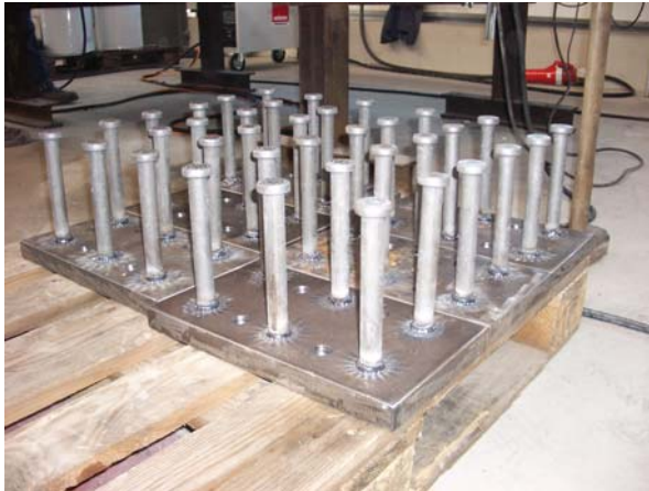
Bild 14: Ankerplatten mit aufgeschweißten KÖCO-Kopfbolzen in der Fertigung
